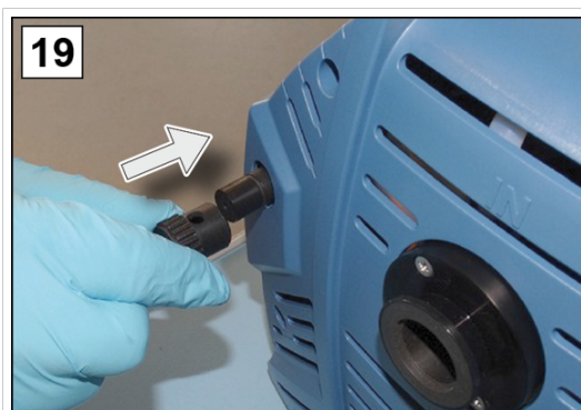
19. Nataknite kapico na plinski balast.
