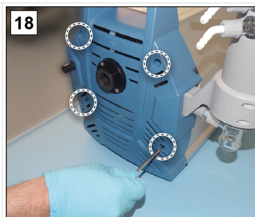
18. Privijte vijake dela ohišja; inbus ključ vel. 4.
