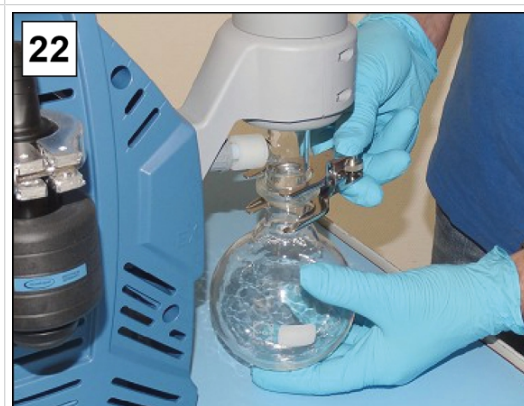
22. Fiksirajte stekleni bat na EK.
