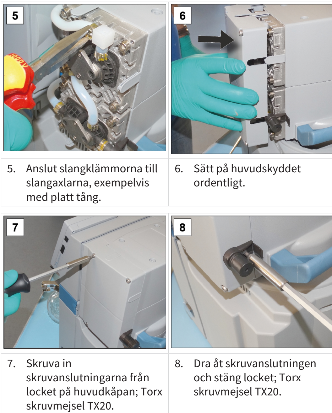
Fig. 8 tillvalsbeskrivning, gäller endast för pumphuvud med gasballast GB
