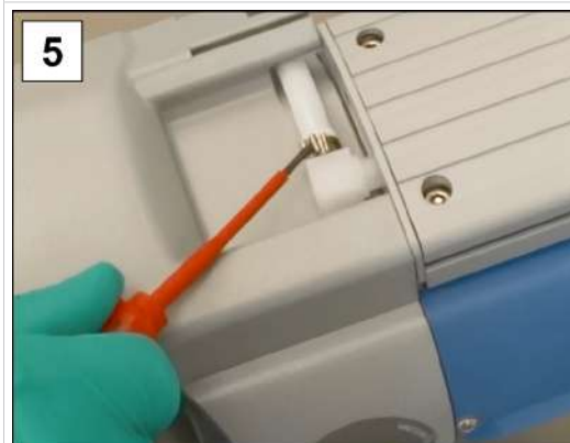
5. Öppna slangklämman; Slitsad skruvmejselstorlek. 1.
