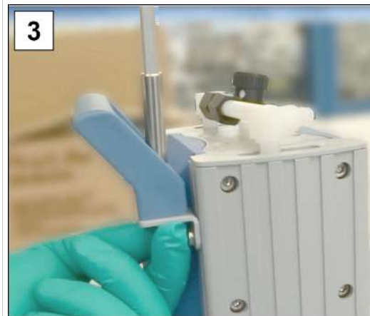
3. Lossa skruvanslutningen från handtaget; Insexnyckelstorlek. 5.
