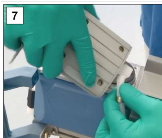
7. Lyft kåpan och dra av den gjutna slangen.
