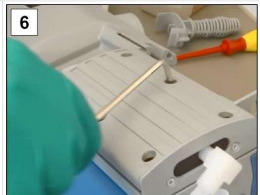
6. Skruva loss skruvanslutningarna; Insexnyckelstorlek. 4: e
