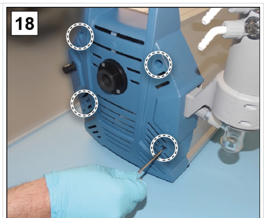
18. Aparafusar os parafusos da parte da caixa; chave Allen tamanho 4.
