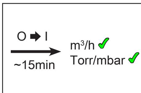
A bomba atinge os valores especificados para a capacidade de sucção e o vácuo final bem como a compatibilidade com o vapor (MZ 1C) apenas à temperatura de funcionamento (após aprox. 15 min.).
