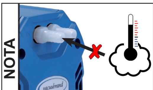
Evitar o fornecimento de calor forte (por exemplo, de gases de processo quentes). Gama de temperaturas admissíveis: ver "Dados técnicos / Temperaturas de entrada de gás".
