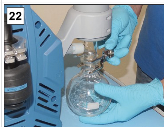
22. Fissare il matraccio sul condensatore EK.
