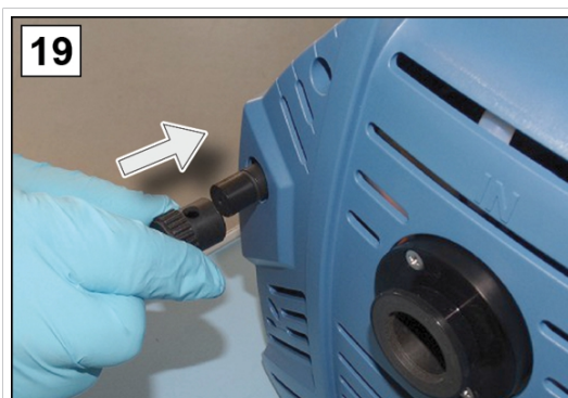
19. Inserire il coperchio sul zavorratore di gas.
