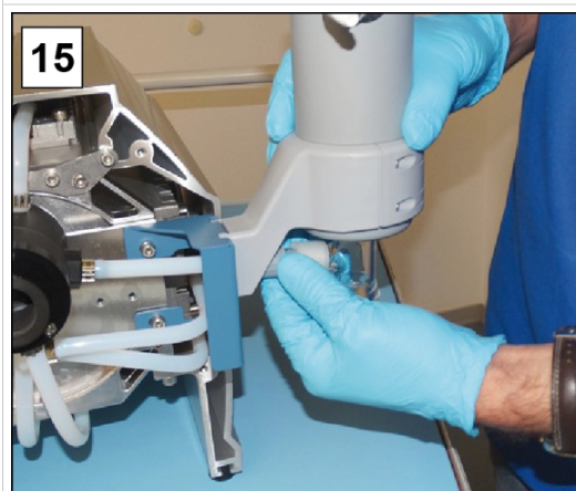
15. Fissare il dado di raccordo dell'alimentazione EK.
