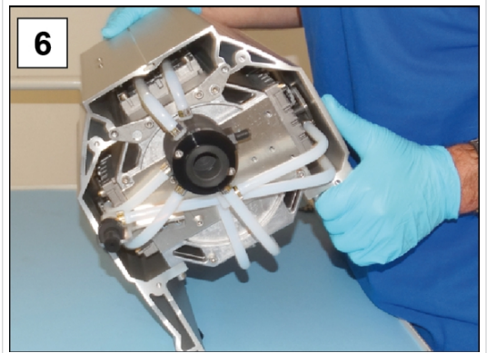
6. Posizionare la pompa sui piedini in gomma.
