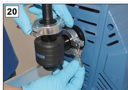
20. Fissare il separatore di aspirazione con l'anello elastico.
