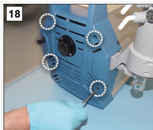
18. Avvitare le viti della parte dell'alloggiamento; chiave a brugola Dim. 4.
