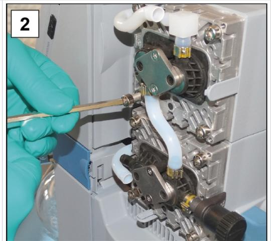
2. Tenere la coppia di testate delle pompe sulla pompa a vuoto e avvitare i collegamenti a vite; chiave a brugola Dim. 5.
