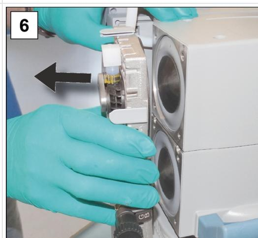
6. Riporre a lato i collegamenti a vite ed estrarre la coppia di testate della pompa.
