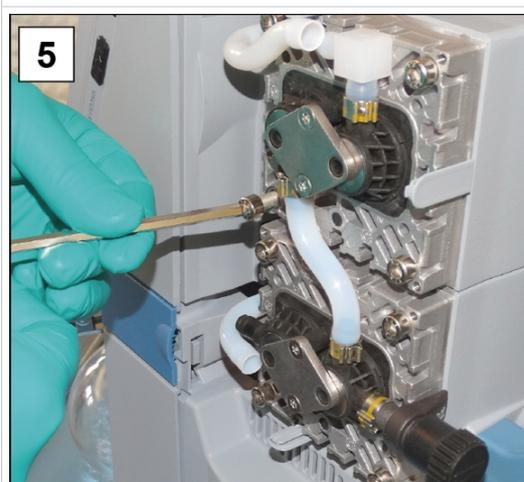
5. Ruotare le viti ad esagono cavo dai coperchi delle testate. Chiave a brugola Dim. 5.
