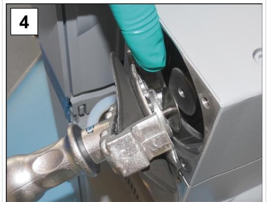
4. Sollevare la membrana con tutti i componenti dalla pompa a vuoto. Qualora le rondelle distanziatrici dovessero attaccarsi alla biella, rimuoverle con attenzione.
