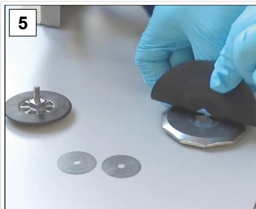
5. Estrarre il disco di serraggio della membrana e rimuovere la membrana usata.
