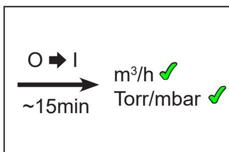
La pompa raggiunge i valori indicati per la potenza di aspirazione e il vuoto finale, nonché per la resistenza al vapore (MZ 1C), solo a temperatura di esercizio (dopo circa 15 minuti).
