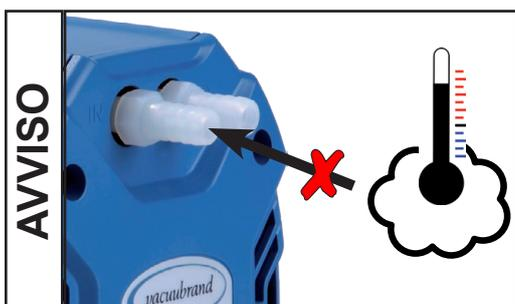
Evitare un forte afflusso di calore (ad es. dovuto a gas di processo caldi). Intervallo di temperature ammesso: vedere "Dati tecnici / Temperature di aspirazione dei gas".
