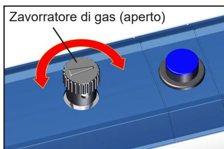
In presenza di **vapori condensabili** (vapore acqueo, solvente, ....):
