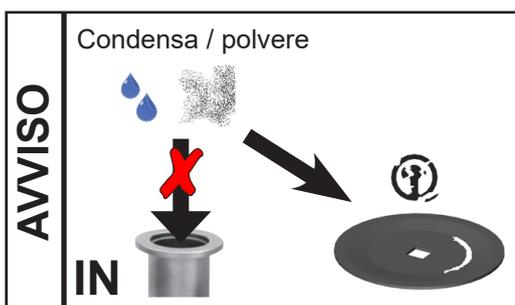
Evitare la condensa nella pompa, come anche colpi d'ariete e polvere, in quanto un trasporto duraturo di liquidi o polvere danneggia membrane e valvole.
