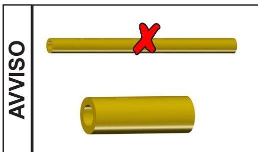
Utilizzare linee di collegamento del vuoto più corte possibili, con grande larghezza nominale, per evitare perdite delle valvole a farfalla.
