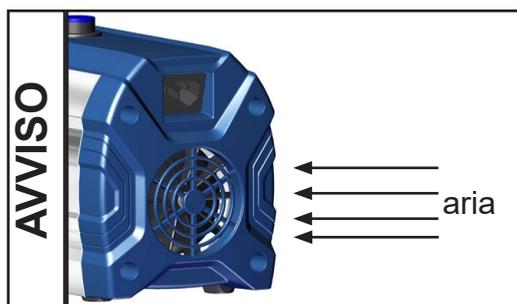
Garantire sempre un apporto sufficiente di aria al ventilatore. Controllare regolarmente la presenza di sporco sul ventilatore. Pulire la griglia del ventilatore sporca per evitare una limitazione di alimentazione dell'aria.
