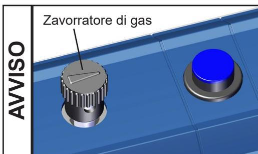
In caso di trasporto di vapori condensabili, azionare la pompa (MZ 1C) con uno zavorratore di gas, al fine di ridurre la condensa delle sostanze pompate (vapore acqueo, solvente,...) all'interno della pompa.
