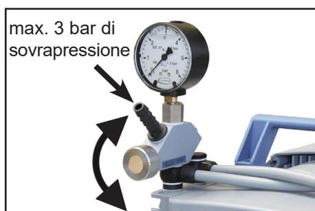
Analogamente si svolge anche la **regolazione della sovrappressione** sul lato di uscita della pompa mediante la testata di regolazione di precisione della pressione:
