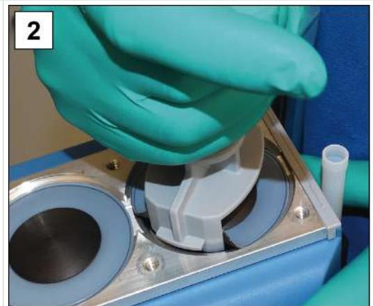
2. Applicare con attenzione la chiave per membrana sul disco di supporto della membrana.
