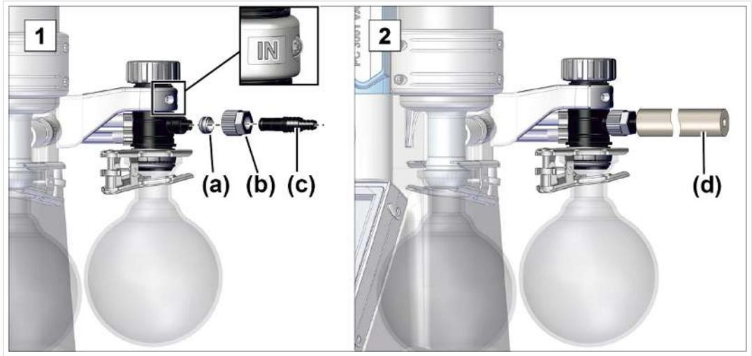
1. Collegare l'anello di tenuta **(a)**, il dado di raccordo **(b)** e il raccordo ondulato per flessibili **(c)** nella maniera indicata.
