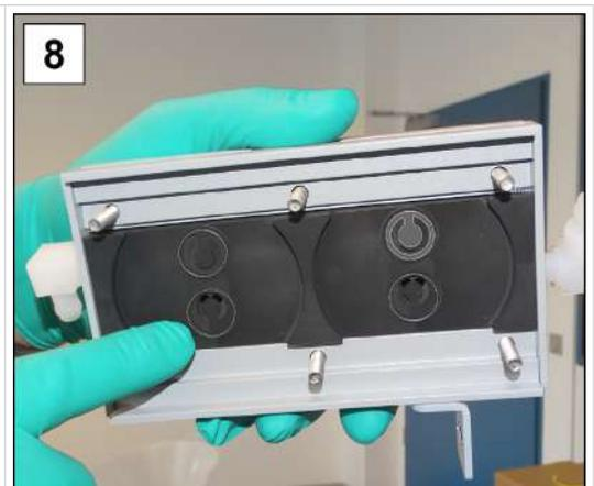
8. Controllare eventuali valvole rimaste attaccate e posizionare il coperchio dell'alloggiamento a lato con i collegamenti a vite.
