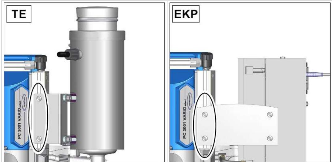
⇒ Svitare le 2 viti di fissaggio; cacciavite a croce Dim. 2.
