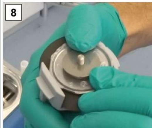
8. Fissare l'unità della membrana nella chiave per membrana.
