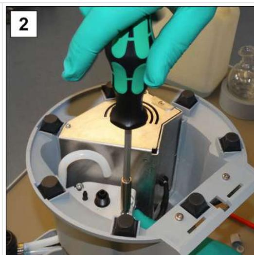
2. Inserire le viti di fissaggio e stringerle bene manualmente; vite a brugola Dim. 3
