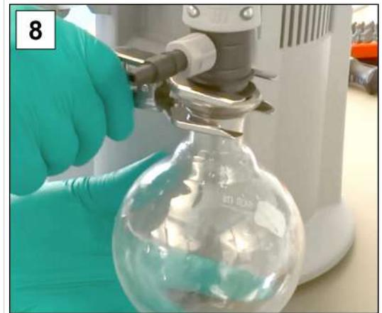
8. Fissare il matraccio di vetro con il morsetto a pinza.
