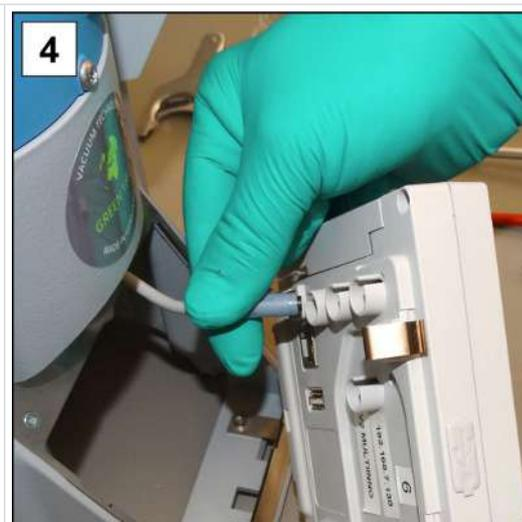
4. Ruotare correttamente la stazione di pompaggio e collegare i cablaggi: VACUU·BUS, spina.
