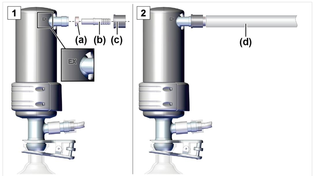
1. Utilizzare l'anello di tenuta in gomma **(a)**, il raccordo ondulato per flessibili **(b)** e il dado di raccordo **(c)** come indicato e avvitare tutto questo sull'attacco.
