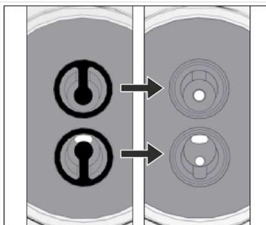
Vista dall'alto in sezione: posizionamento corretto delle valvole.
