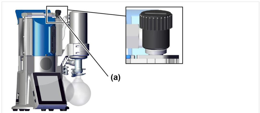
Qualora si debba utilizzare aria ambientale come zavorratore di gas, non occorre collegare nulla sulla stazione di pompaggio; in merito alla valvola per zavorratore di gas **(a)**, vedere anche il capitolo: → **Funzionamento con zavorratore di gas sulla pagina 52**
