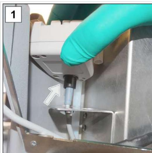
1. Inserire la spina VACUU·BUS e posizionare il sensore sul supporto.
