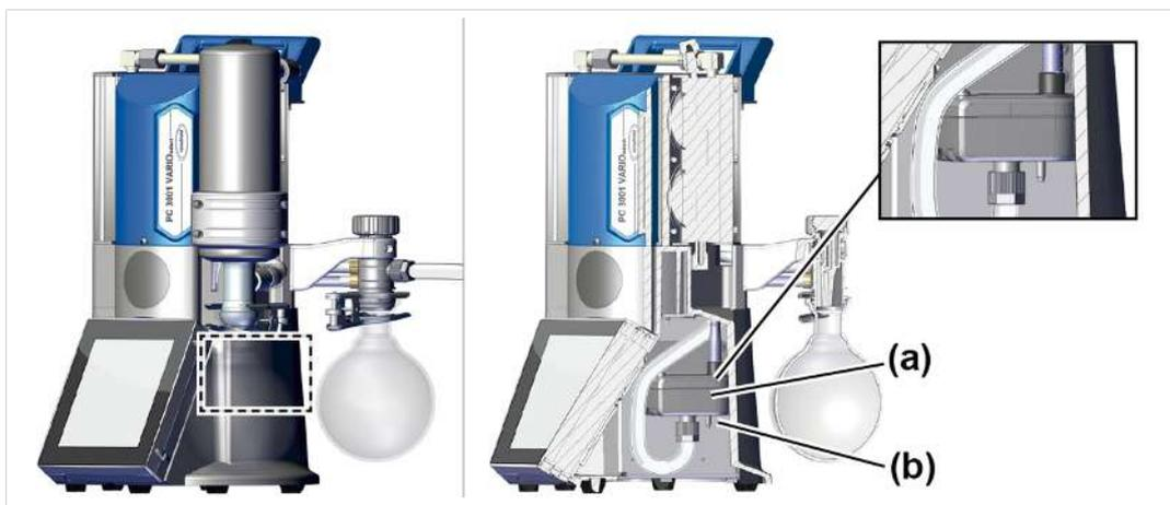
Per la ventilazione con aria ambientale non si deve collegare nulla alla valvola di ventilazione **(b)** del sensore **(a)**.
