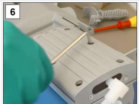
6. Svitare i collegamenti a vite; chiave a brugola Dim. 4.
