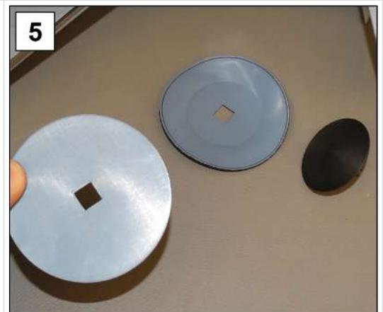
5. Disassemblare l'unità e prendere una nuova membrana; set di guarnizioni #20696828.
