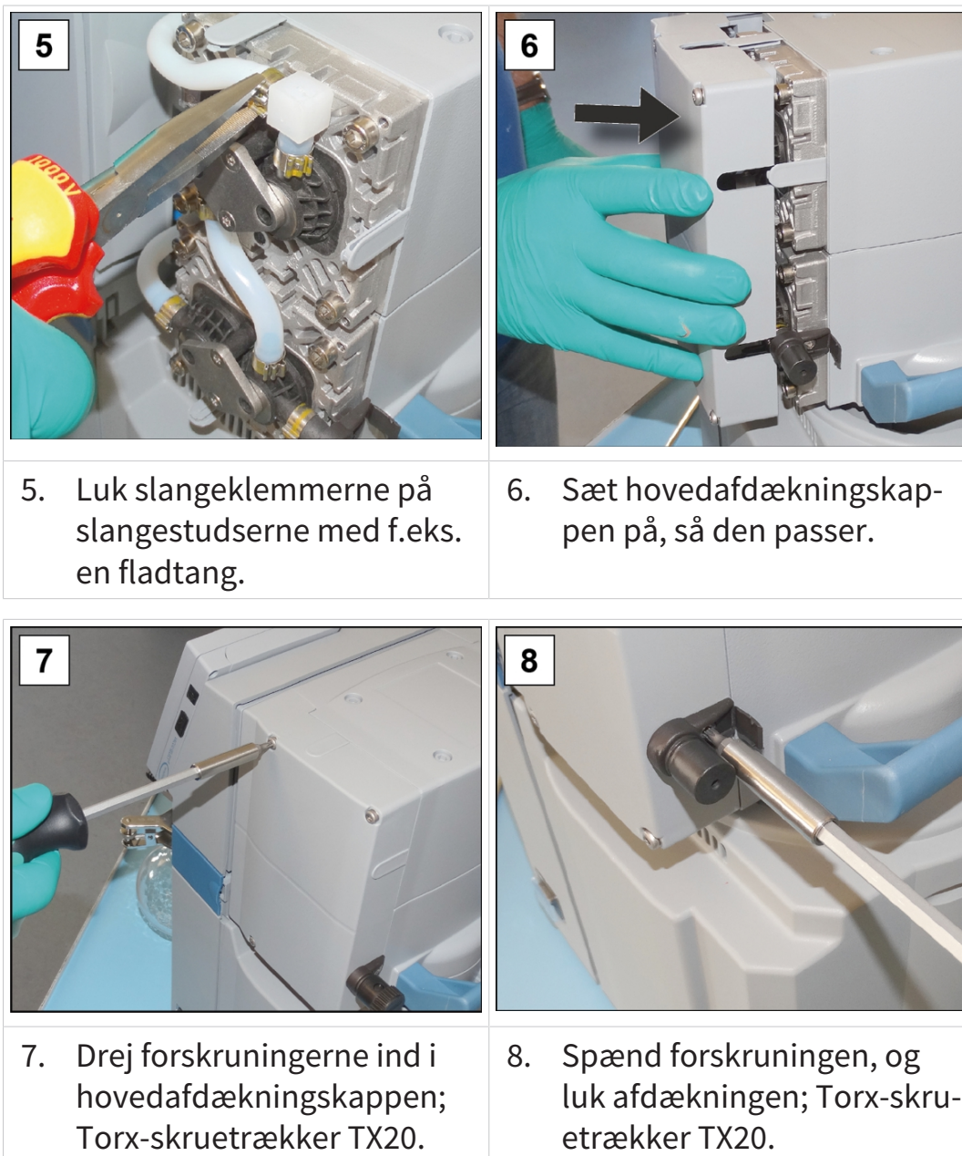
Fig. 8 valgfri beskrivelse, gælder kun for pumpehoved med gasballast GB
