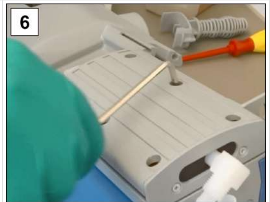
6. Løsn forskruingerne; krydskærv-skruestrækker str. 4.
