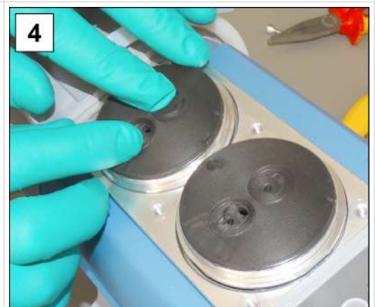
4. Læg de nye ventiler på, og juster dem; pakningsæt# 20696828.
