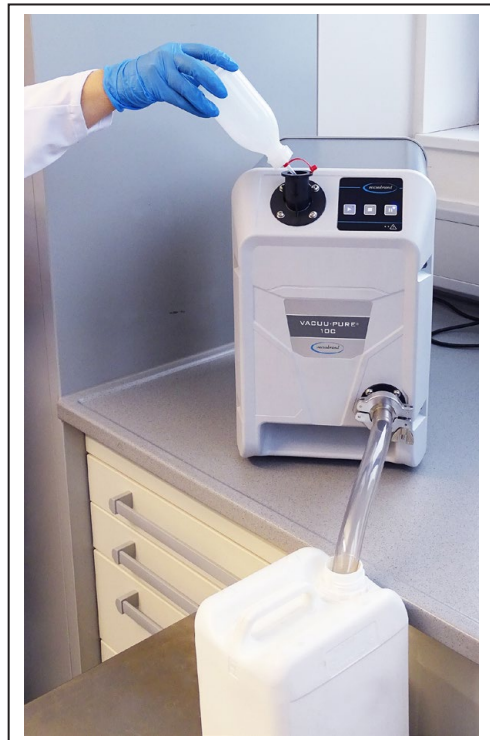
Eksempel på arrangement til skylning af vakuumpumpen
