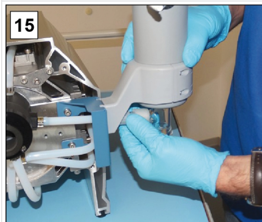
15. Zamocować nakrętkę nasadową EK na dolocie.
