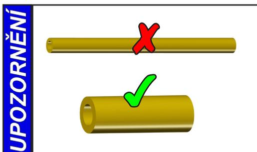
Používejte co možná nejkratší vakuová spojovací vedení velké jmenovité světlosti, aby se zabránilo ztrátám škrcením.
