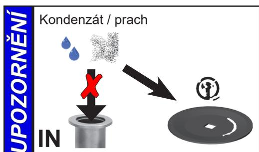
Zabraňte kondenzaci v čerpadle a rovněž srážení kapalin a prachu, neboť trvalé čerpání kapalin nebo prachu poškodí membránu a ventily.
