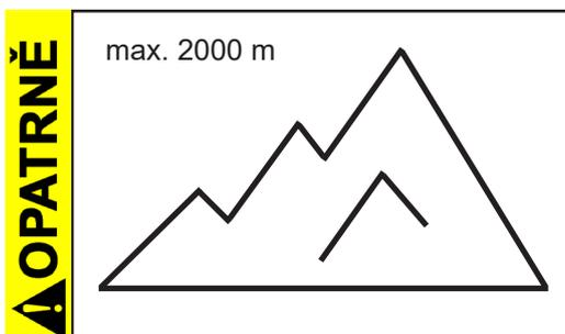
• Při místě instalace nad 2000 m nad mořem (nebezpečí nedostatečného přívodu chladicího vzduchu) je třeba učinit vhodná opatření a zabezpečení.
