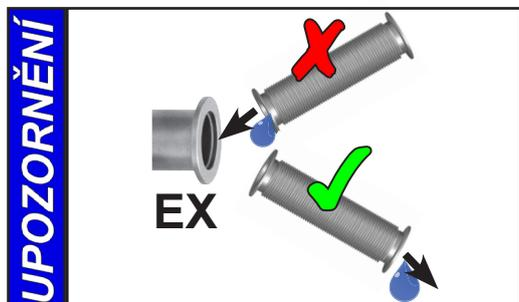
Výfuková vedení vždy pokládejte klesající nebo učiňte jiná opatření k zabránění zpětnému toku kondenzátu z výfukového vedení do čerpadla.
