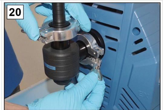
20. 用夹紧圈固定进气分离器。
