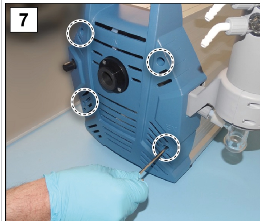
7. 从壳体件前面旋下 4 个螺栓；4 号内六角扳手。
