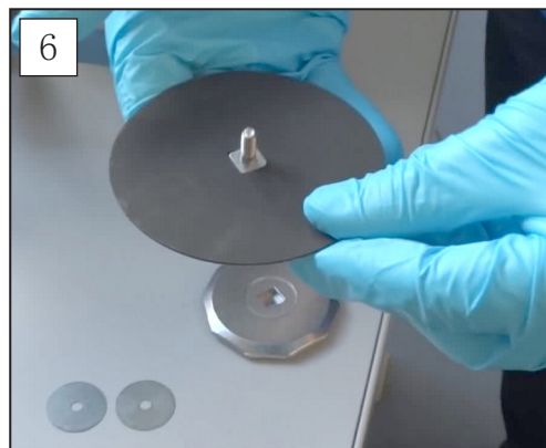
6. 将新的隔膜放在隔膜锁紧盘的四角上。
