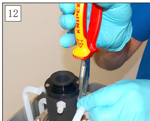
12. 闭合软管轴上的软件夹，例如使用一个扁嘴钳。
