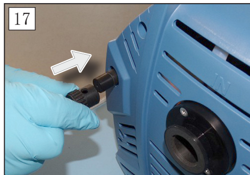
17. 将气锁盖插到气锁上。
