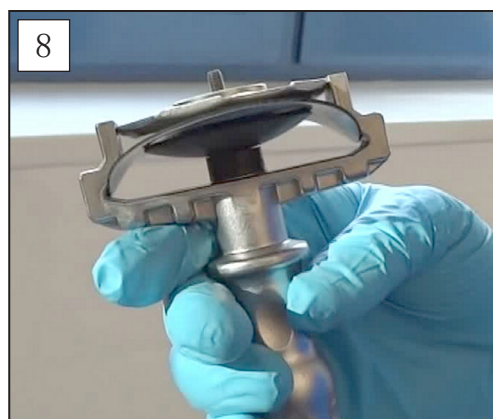
8. 将隔膜组件固定在隔膜扳手中。
