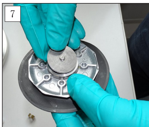
7. 将所有间隔垫片插到螺纹销上。
