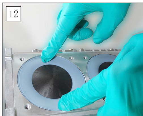
12. 然后，请将隔膜小心地居中、齐平按到外壳开口中。
