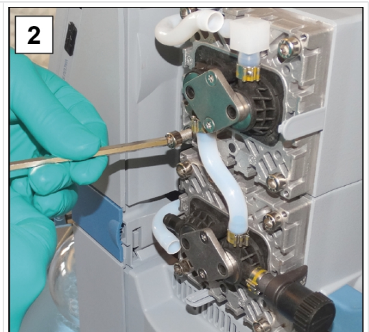
2. 将泵头对按在真空泵上，旋入螺纹紧固件；5号内六角扳手。
