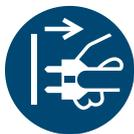
➔ 在对设备进行任何干预操作前，必须要断开电源连接，然后等待五秒钟，直到电容器放电结束。
