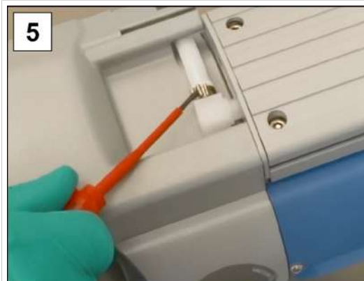
5. 打开软管夹；1号开槽螺丝刀。
