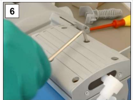
6. 旋出螺纹紧固件；4号内六角扳手。
