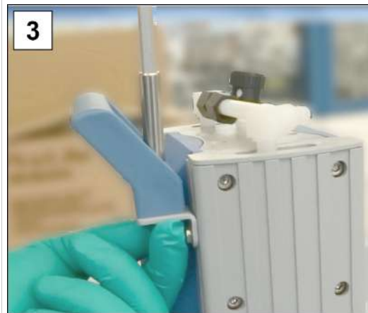
3. 松开扶手上的螺纹紧固件；5号内六角扳手。
