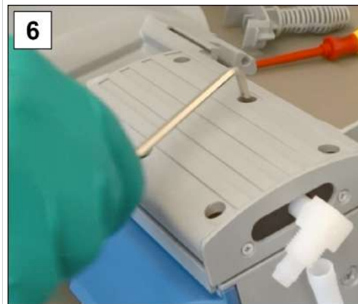
6. 平整安放外壳盖并旋入螺纹紧固件；4号内六角扳手，拧紧力矩6 Nm。
