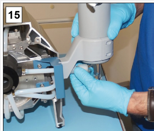
15. Draai de wartelmoer van de aanvoer van de emissiecondensator vast.
