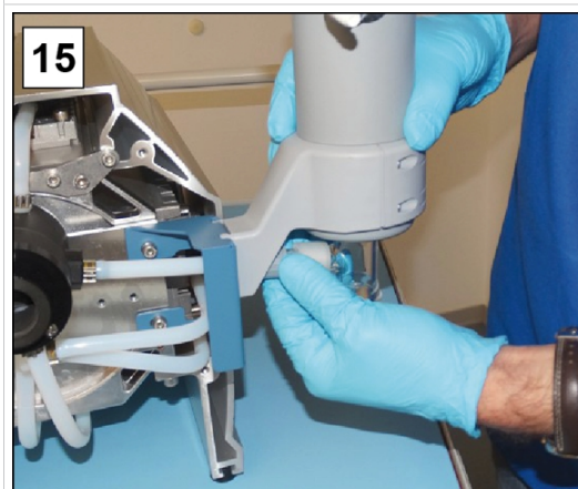
15. Fixez l'écrou-raccord de l'entrée EK.
