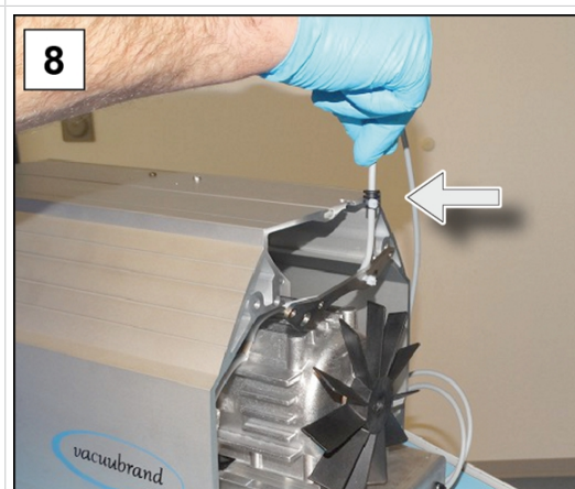
8. Fixez le câble dans le renfoncement à l'arrière.
