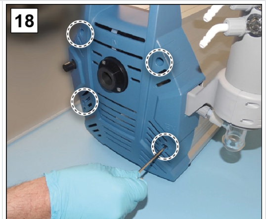
18. Vissez les vis de la partie du boîtier ; clé à six pans creux T 4.
