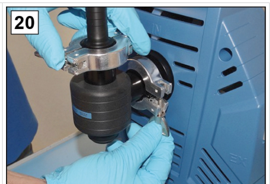
20. Fixez le séparateur d'aspiration avec la bague de serrage.
