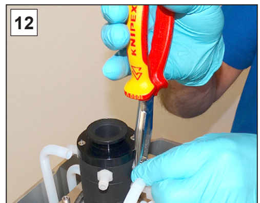
12. Fermez les colliers de serrage pour tuyau sur les raccords cannelés, p. ex. à l'aide d'une pince plate.
