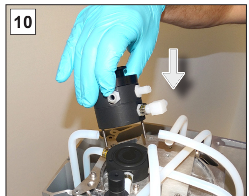
10. Mettez le distributeur d'aspiration en place, positionnez les vis et vissez-les fermement à l'aide d'un tournevis cruciforme de taille 2.
