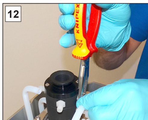
12. Fermez les colliers de serrage pour tuyau sur les raccords cannelés, p. ex. à l'aide d'une pince plate.
