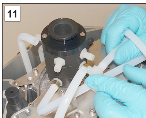
11. Remplacez les tuyaux modelés sur les raccords.
