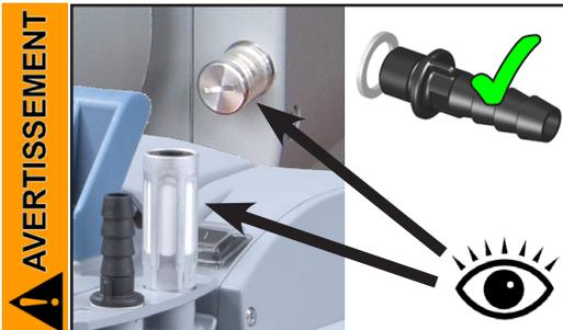
**Opération de la pompe avec silencieux (optionnel) au refoulement:**
