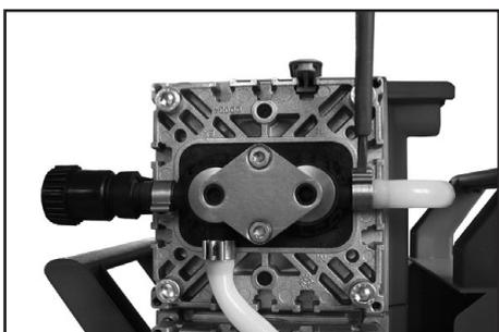
Desserrez à la tête de clapet le raccordement du tuyau de connexion vers l'autre côté de la pompe.
