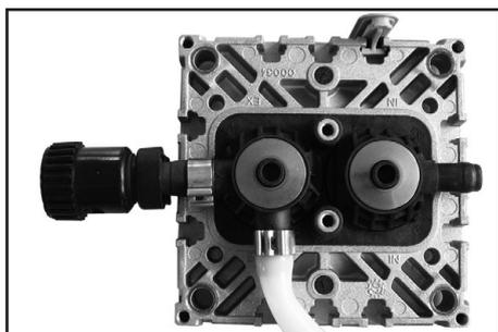
➔ Repositionnez les têtes de clapet avec l'embout, le tube de connexion ou les fixations de raccord le cas échéant, et les rondelles-ressorts. Positionnez les rondelles-ressorts avec leur voûte vers le haut.
