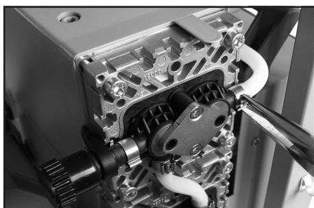
Installez le raccordement du tuyau de connexion vers l'autre côté de la pompe à la tête de clapet.
