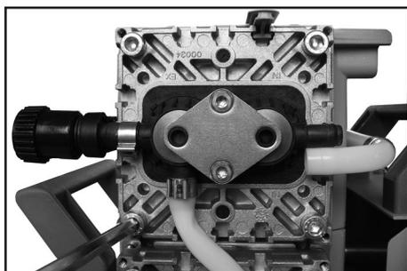
➔ A l'aide d'une clé à six pans, vissez en diagonale les vis à tête cylindrique d'abord à la main puis serrez.
