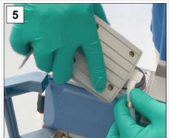
5. Une fois toutes les clapets correctement positionnées, commencez par raccorder le tuyau modelé.
