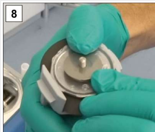
8. Positionnez le module de la membrane dans la clé pour les membranes.
