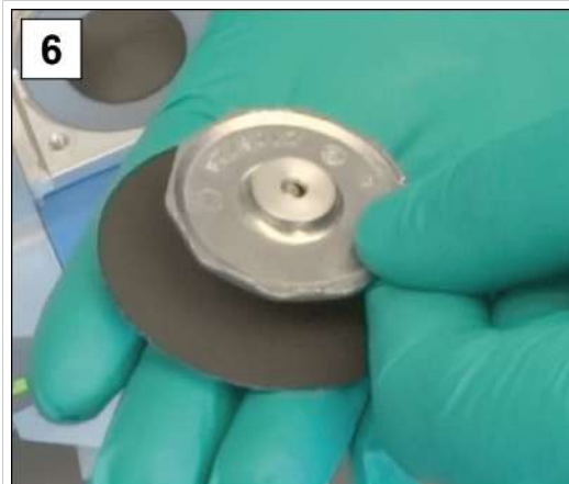
6. Réassemblez le module et veillez à un positionnement correct sur la partie carrée.
