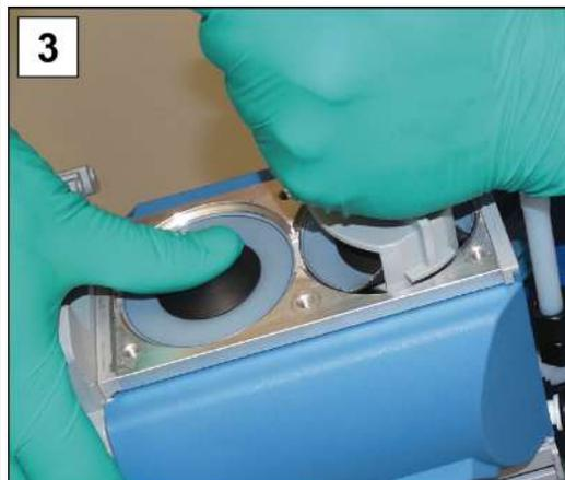
3. Dévissez le module avec la clé pour les membranes ainsi positionnée.
