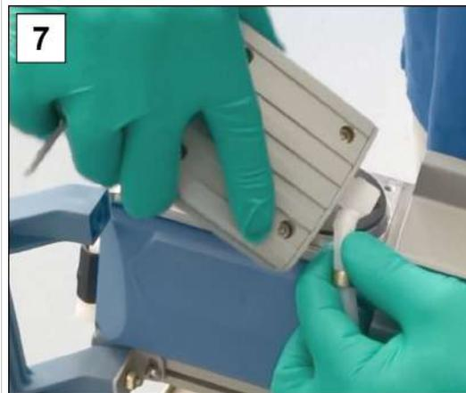
7. Soulevez le couvercle du boîtier et débranchez le tuyau modelé.
