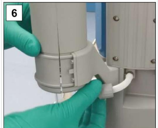
6. Remontez le tuyau modelé et serrez l'écrou-raccord fermement.
