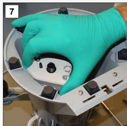
7. Débranchez le connecteur VACUU·BUS situé dessous, puis retirez le capteur.
