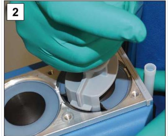
2. Positionnez avec précaution la clé pour les membranes sur le disque de support de membrane.
