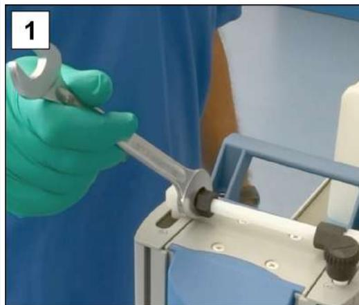
1. Desserrez l'écrou-raccord à l'aide de la clé à fourche SW17.
