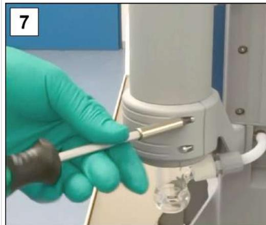
7. Fixez le support à l'aide d'un tournevis Torx TX10. Avec un EKP ou un TE, vissez la plaque de retenue à l'aide du tournevis cruciforme de taille 2.
