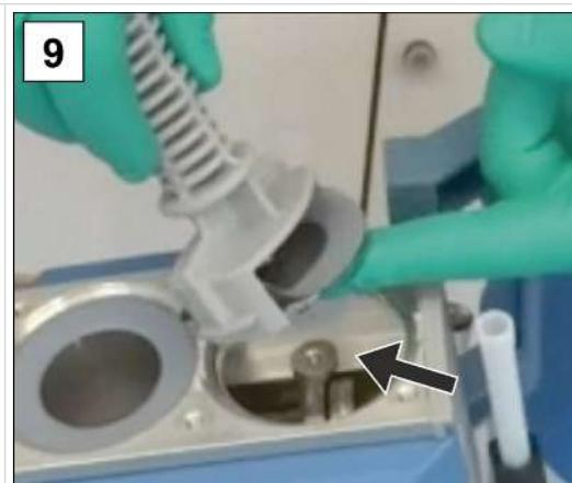
9. Maintenez les rondelles en place et positionnez le module sur le filetage de bielle.
