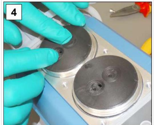
4. Posez les nouveaux clapets et orientez-les correctement (jeu de joints MD 1C).
