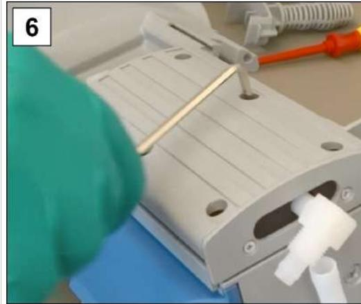
6. Posez le couvercle du boîtier à plat et revissez les vis à l'aide de la clé Allen de taille 4, au couple de serrage de 6 Nm.
