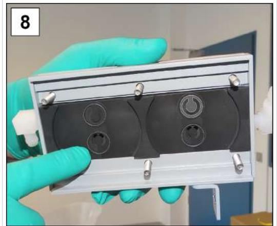
8. Vérifiez qu'aucun clapet ne soit resté collé au couvercle du boîtier et mettez ce dernier de côté, avec les vis.
