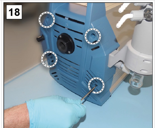
18. Drehen Sie die Schrauben vom Gehäuseteil ein; Innensechskantschlüssel Gr. 4.
