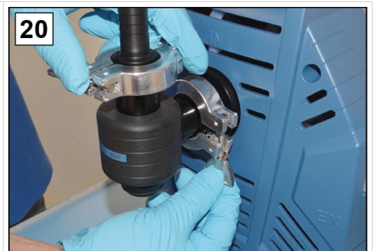
20. Fixieren Sie den Ansaugabscheider mit dem Spannring.
