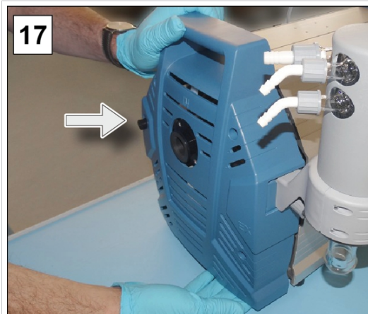
17. Setzen Sie das Gehäuseteil vorne auf.
