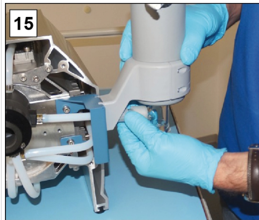
15. Fixieren Sie die Überwurfmutter vom Zulauf EK.
