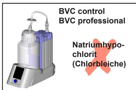
Aggressive Desinfektionsmittel, die Chlor oder Sauerstoffradikale freisetzen, z.B. Natriumhypochlorit (Chlorbleiche) oder Peroxoverbindungen, können das Material (Polypropylen) der 4-Liter Sammelflasche des BVC und anderer Komponenten angreifen. Dies kann zu Spannungsrissen und Brechen der 4-Liter PP-Sammelflasche führen.
