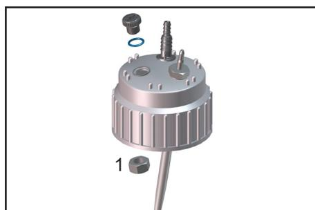
**Nur BVC mit Polypropylen-Flasche:** Gegenmutter (1) in der Schraubkappe lösen.
