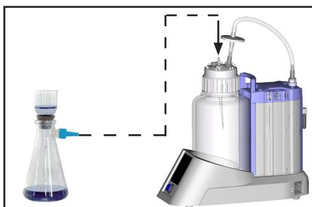
Saugflasche an den Anschluss des VacuuHandControl am Flaschenkopf oder über zusätzliche Schlauchwelle (Zubehör, Bestellnummer 20638509) anschließen, siehe „Montage einer Schlauchwelle am Flaschenkopf des BVC“.
