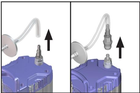
➔ Je nach Ausführung Verbindungsschlauch an der Schlauchwelle abziehen oder Schnellkupplung lösen.
