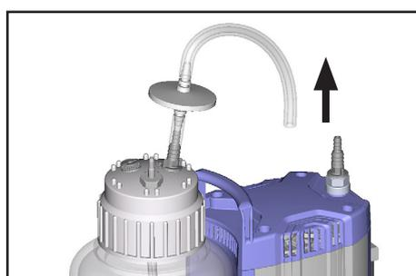
Verbindungsschlauch am Pumpeneinlass abziehen, ggf. Anschlüsse abkoppeln.
