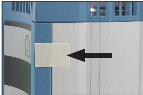
➔ Blende am Pumpengehäuse mit Klebeband fixieren.
