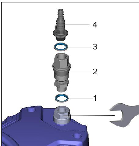
Kupplung (2) mit Dichtringen (1, 3) und Schlauchwelle (4) montieren.
