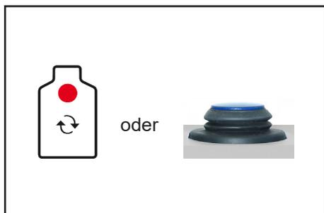
Vor dem Austausch der Sammelflasche Wechseltaste betätigen (rote LED wechselt von blinkend zu leuchtend) oder BVC ausschalten, damit die Pumpe nicht läuft, solange keine Flasche angeschlossen ist.
