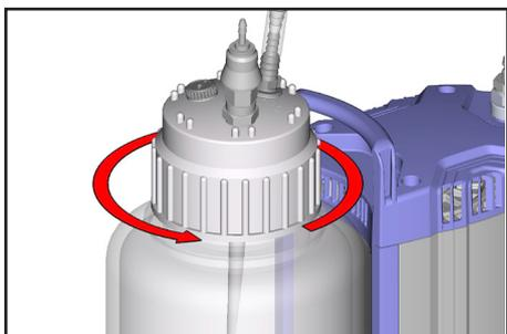
Schraubkappe der Sammelflasche lösen (nach Belüften).
