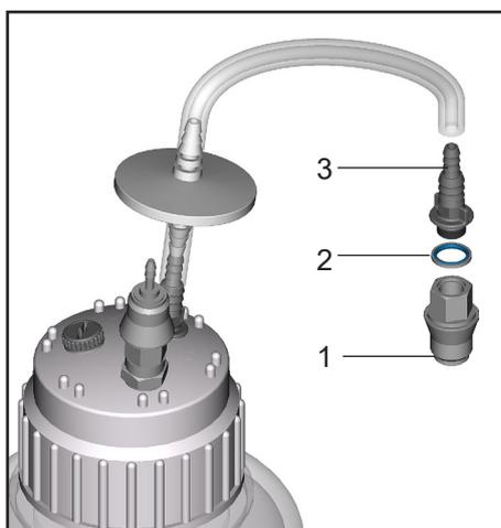
Kupplungsteil (1) mit Dichtring (2) und Schlauchwelle (3) montieren.
