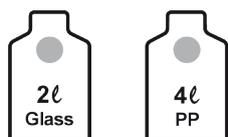
Die Bedienflächen werden zur Auswahl der verwendeten Flaschengröße (2 Liter Glasflasche oder 4 Liter Polypropylen-Flasche) und damit auch zur Aktivierung des entsprechenden Füllstandssensors verwendet. Zur Betätigung >1 Sekunde den Schriftzug „2l Glass“ oder „4l PP“ berühren. Die LED der ausgewählten Flasche leuchtet blau.
