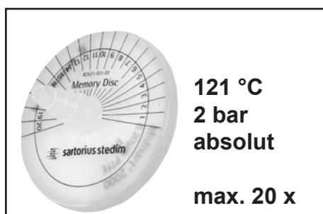
Die Anzahl der durchgeführten Autoklavierungen kann auf der aufgesteckten Kunststoffscheibe (Memory Disc) des Filters markiert werden (max. 20 Autoklavierungen gemäß Herstellerangabe).
