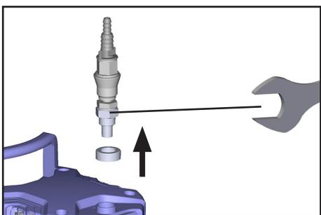
➔ Schlauchwelle oder Kupplung mit Schlauchwelle mit Gabelschlüssel herausdrehen.
