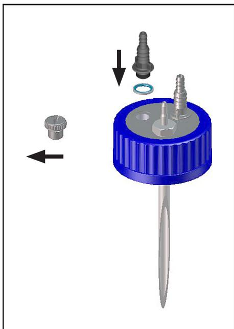
Schlauchwelle mit Dichtring einschrauben.
