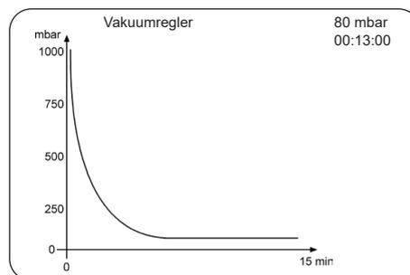
Bei der Auswahl "Grafik" wird der Druckverlauf über die Zeit dargestellt.
