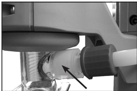
Überdruckventil am Emissionskondensator ..... **20638821**
