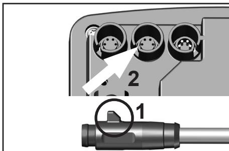
Abhängig von der technischen Ausführung haben die Anschlüsse der VACUU•BUS-Kabel eine Nase.
