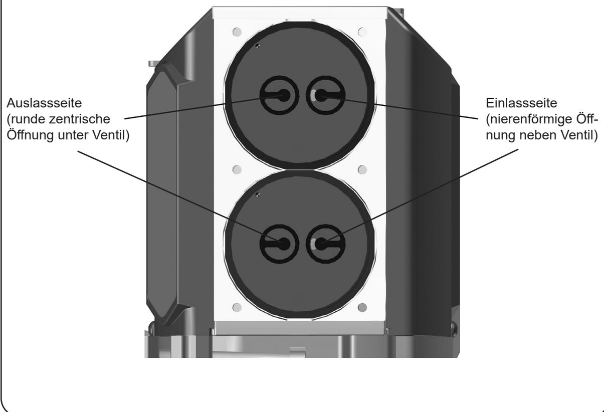
**Montage des Gehäusedeckels auf der Seite des Emissionskondensators**
