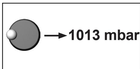
Ein Abgleich auf Atmosphärendruck ist nur bei einem Druck > 700 mbar möglich.
