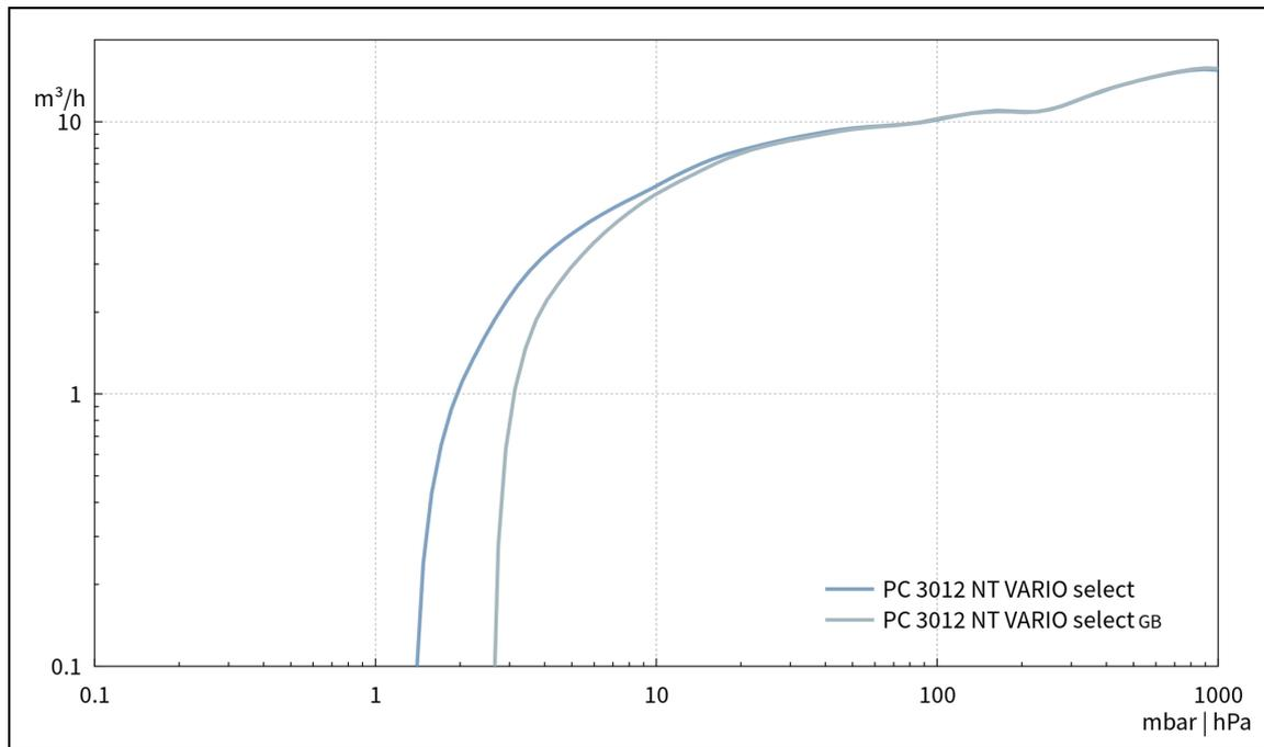
Courbe de pompage à 50 Hz (réservoir 100l)
