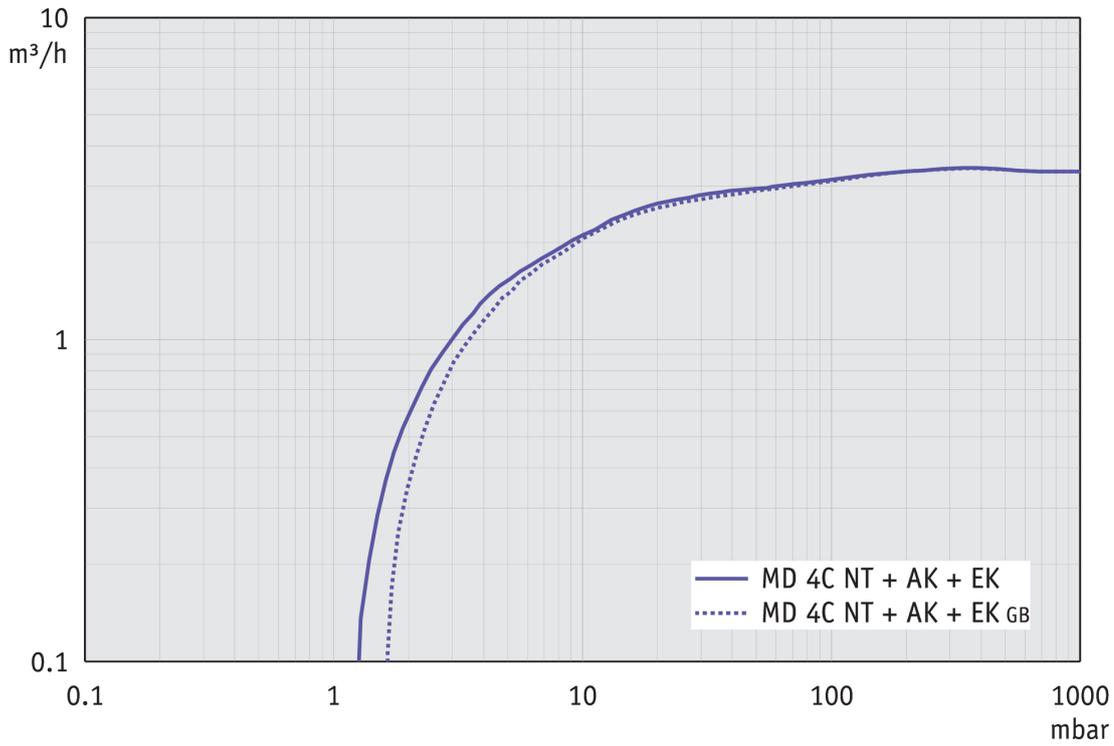
Abpumpkurve bei 50 Hz (10 l Behälter)
