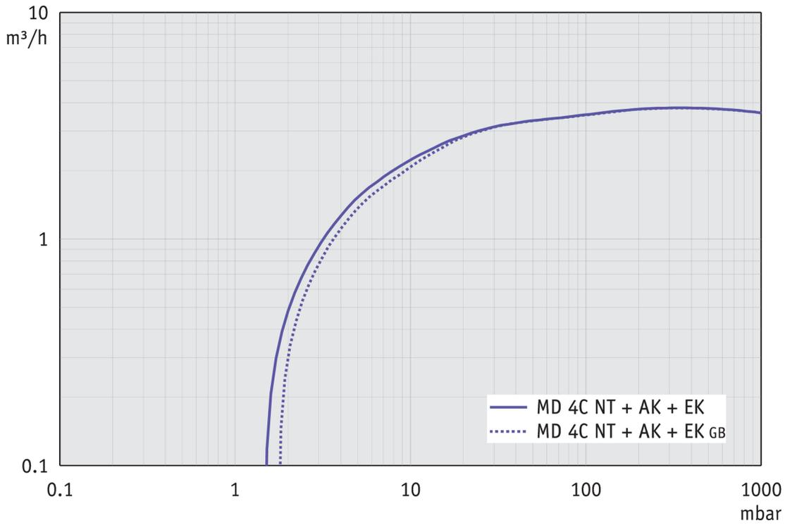
Abpumpkurve bei 60 Hz (10 l Behälter)
