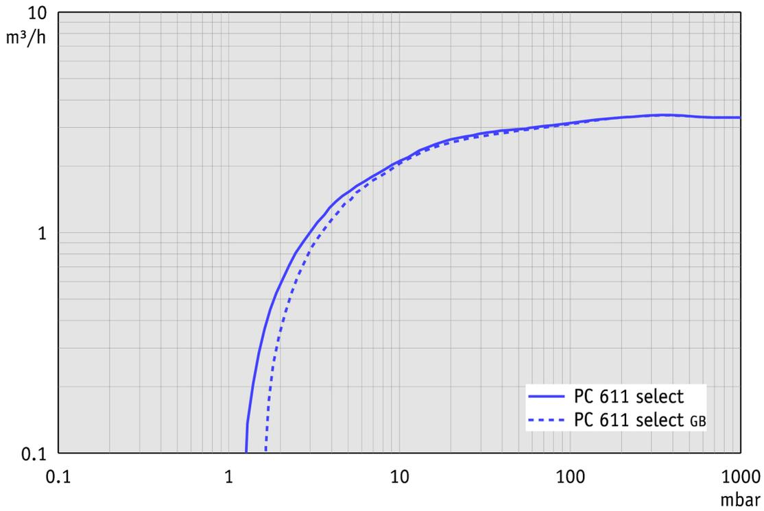
Abpumpkurve bei 50 Hz (10 l Behälter)
