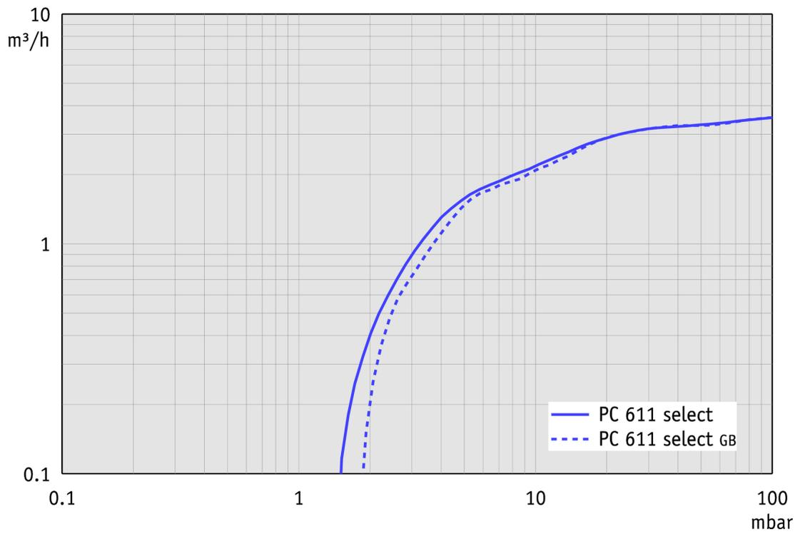
Abpumpkurve bei 60 Hz (10 l Behälter)
