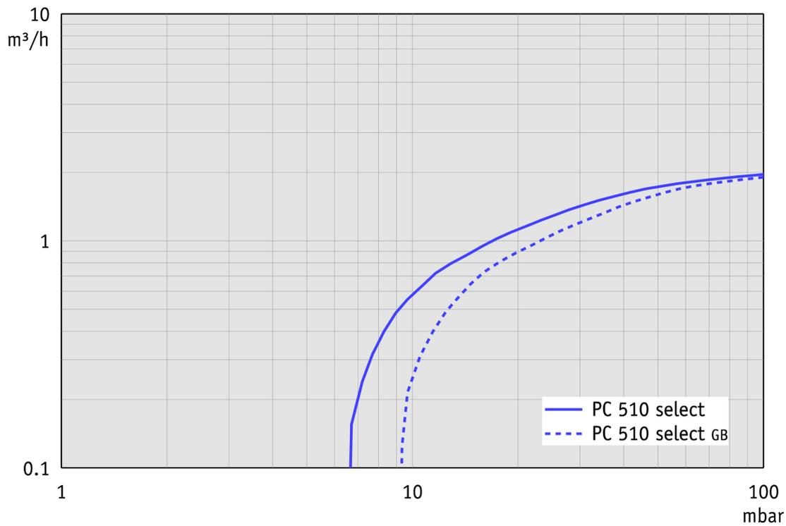
Abpumpkurve bei 60 Hz (10 l Behälter)
