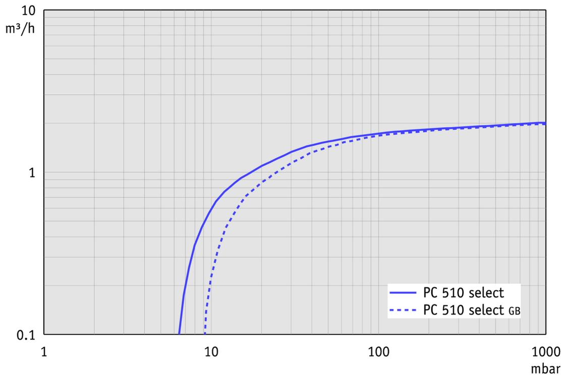
Abpumpkurve bei 50 Hz (10 l Behälter)
