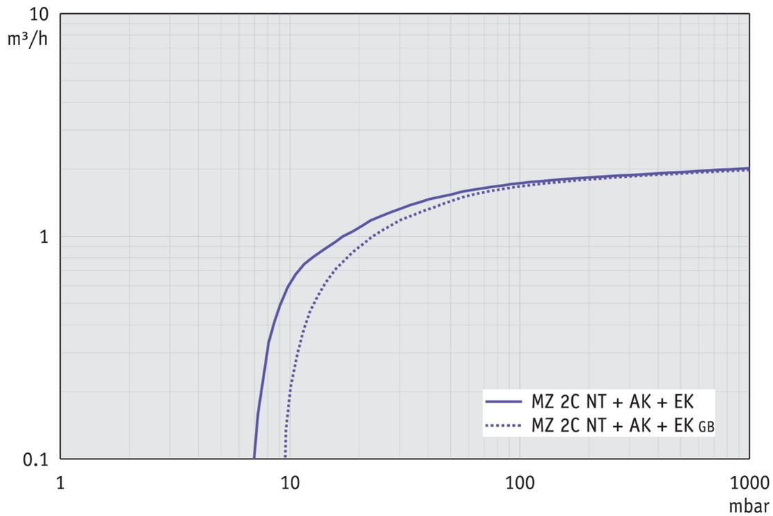
Abpumpkurve bei 50 Hz (10 l Behälter)
