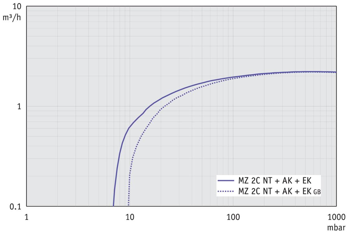
Abpumpkurve bei 60 Hz (10 l Behälter)
