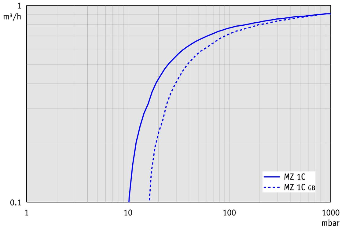
Abpumpkurve bei 60 Hz (10 l Behälter)
