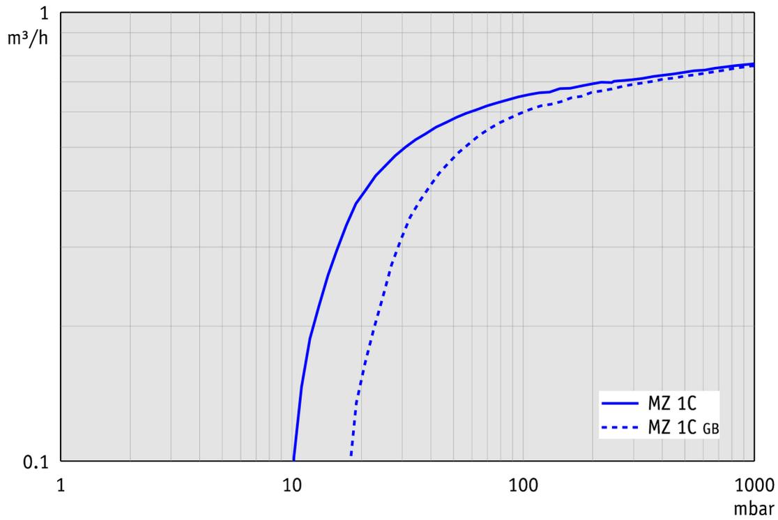
Abpumpkurve bei 50 Hz (10 l Behälter)
