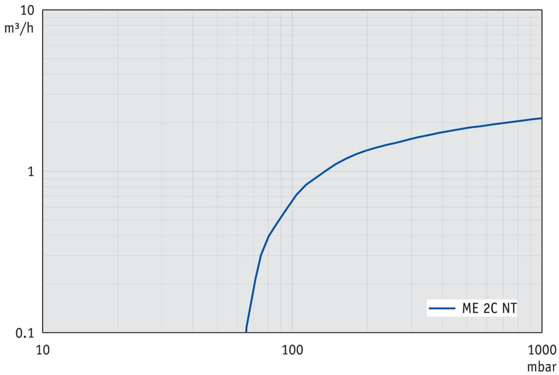
Abpumpkurve bei 50 Hz (10 l Behälter)
