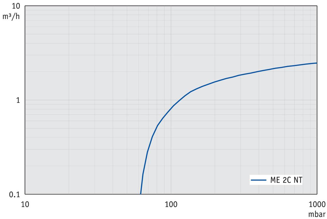
Abpumpkurve bei 60 Hz (10 l Behälter)
