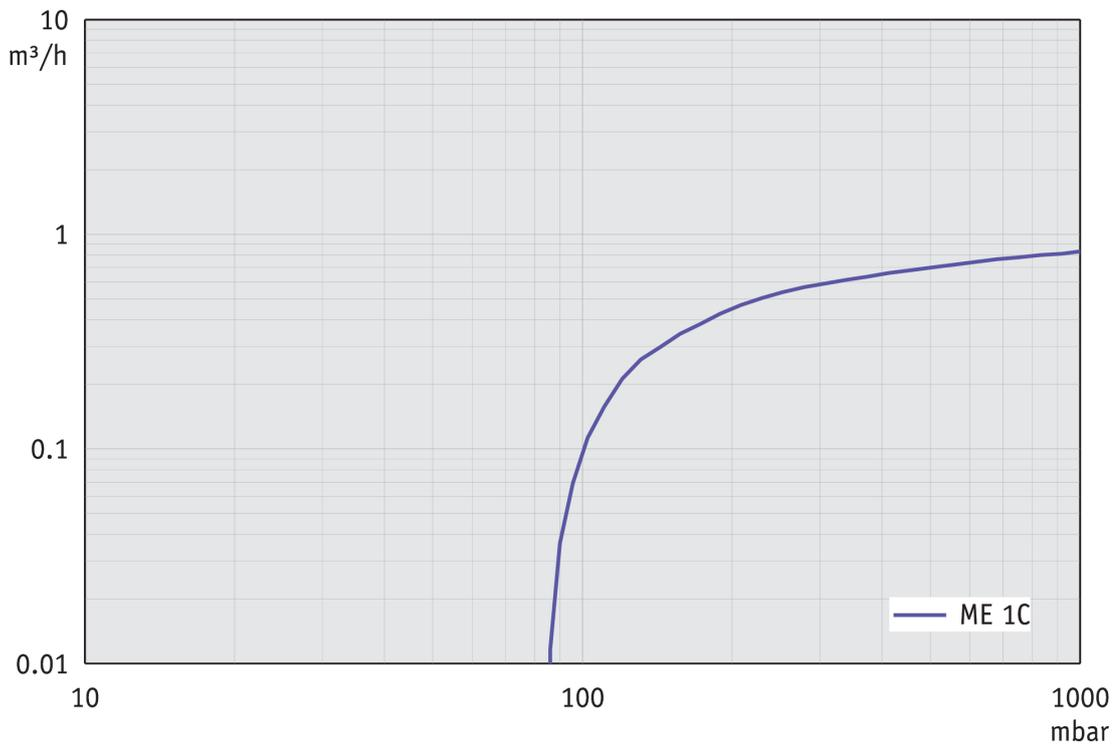
Abpumpkurve bei 60 Hz (10 l Behälter)
