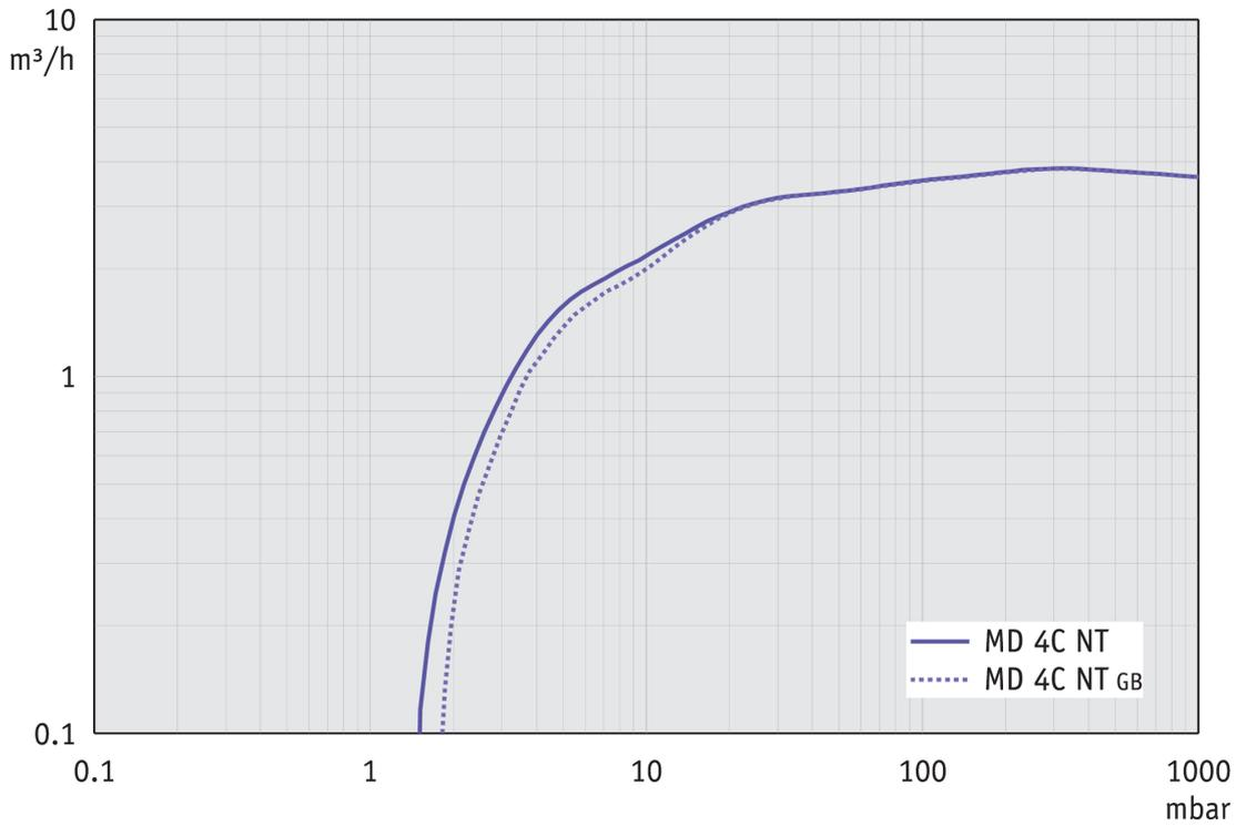
Abpumpkurve bei 60 Hz (10 l Behälter)
