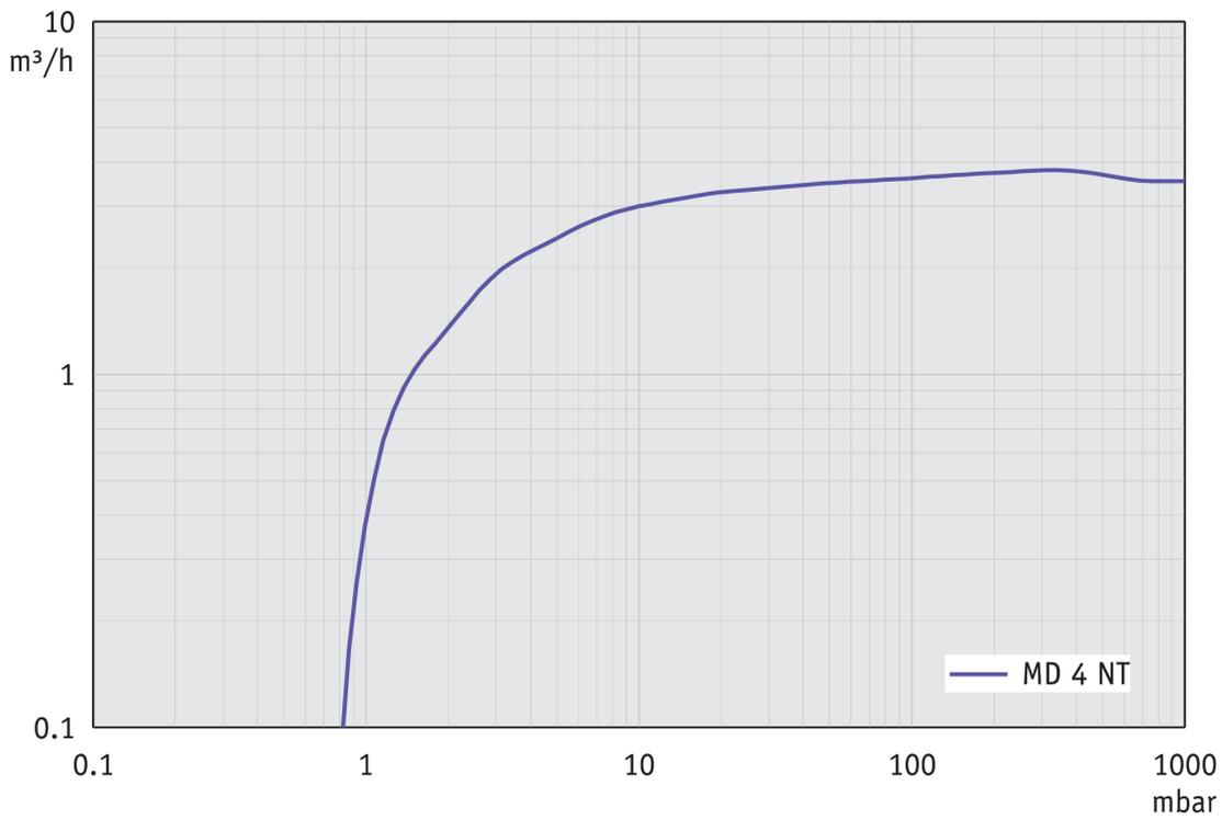
Abpumpkurve bei 50 Hz (10 l Behälter)
