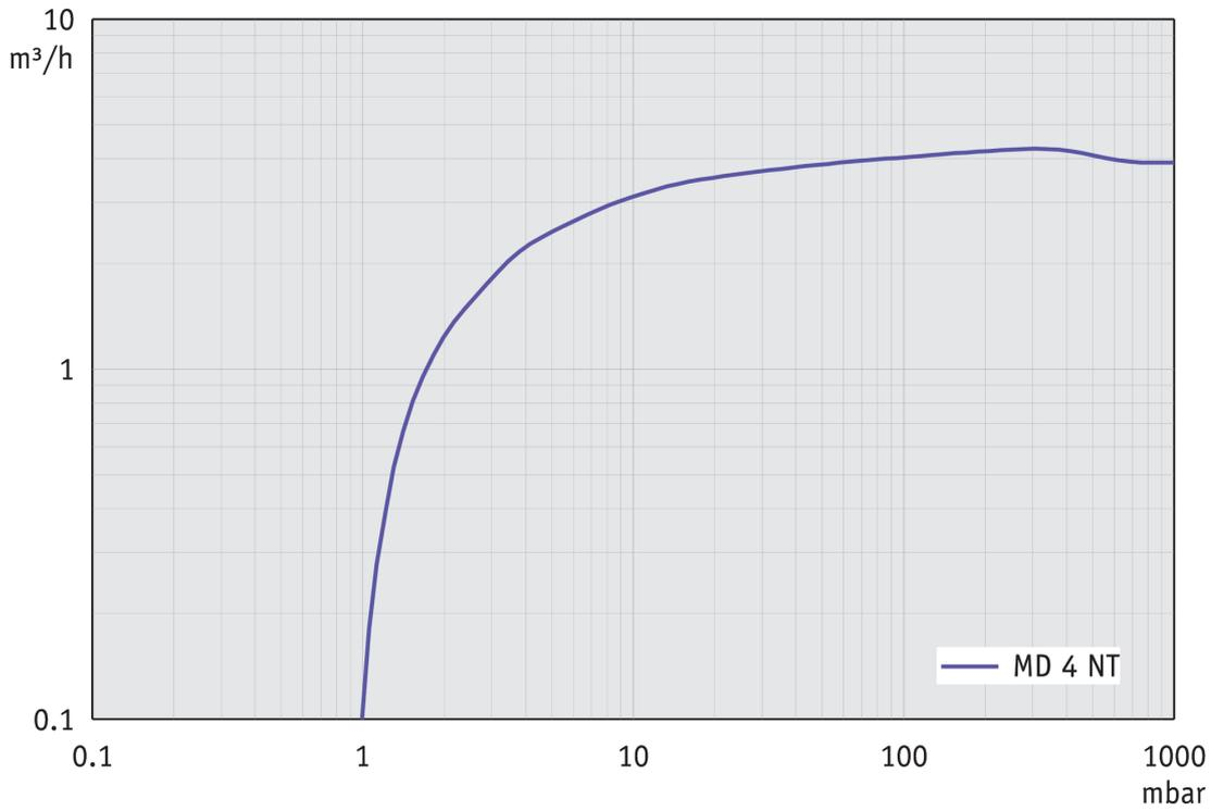
Abpumpkurve bei 60 Hz (10 l Behälter)
