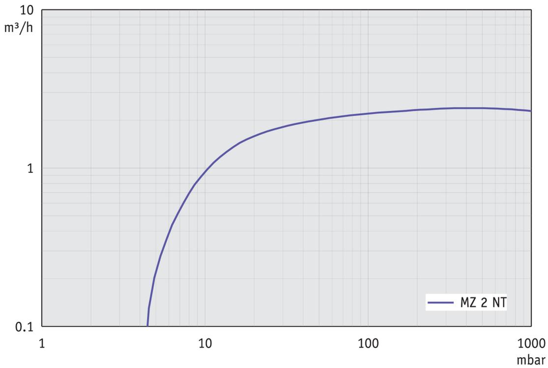
Abpumpkurve bei 60 Hz (10 l Behälter)
