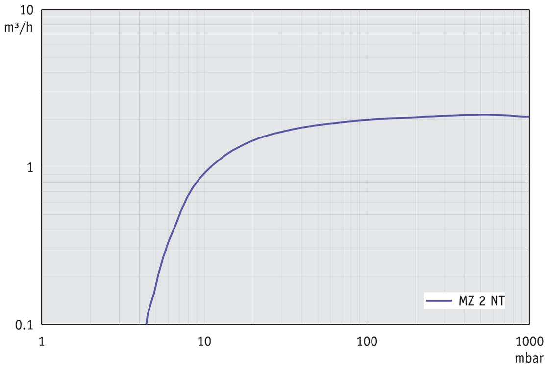
Abpumpkurve bei 50 Hz (10 l Behälter)
