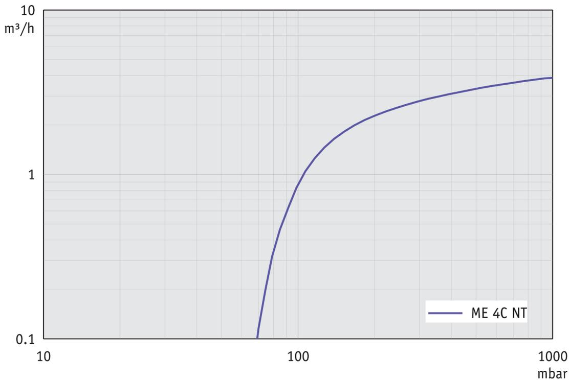
Abpumpkurve bei 50 Hz (10 l Behälter)
