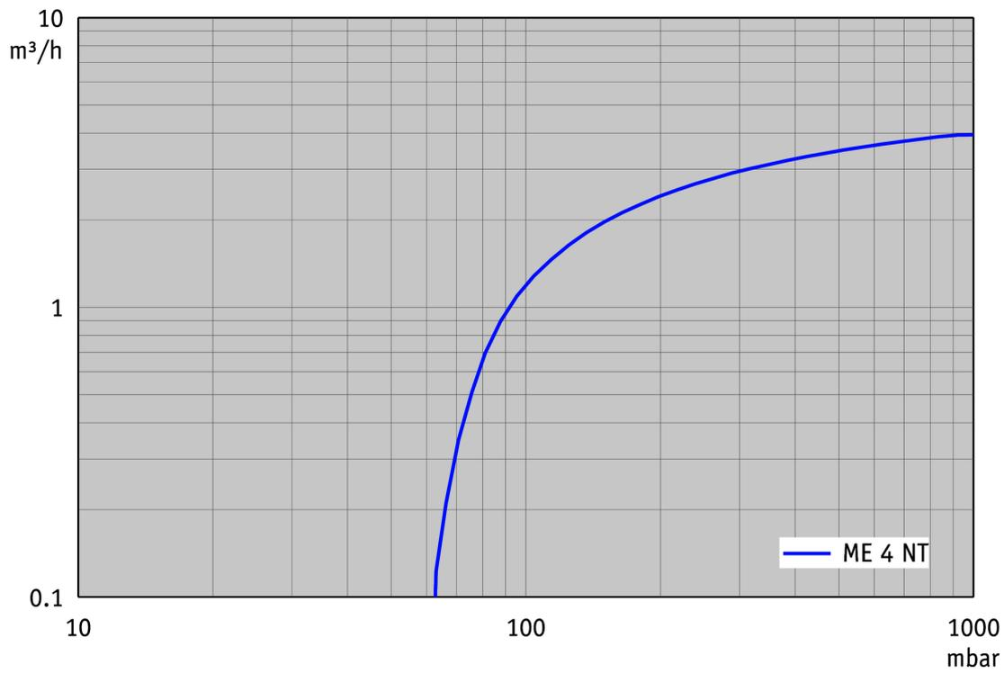
Abpumpkurve bei 50 Hz (10 l Behälter)
