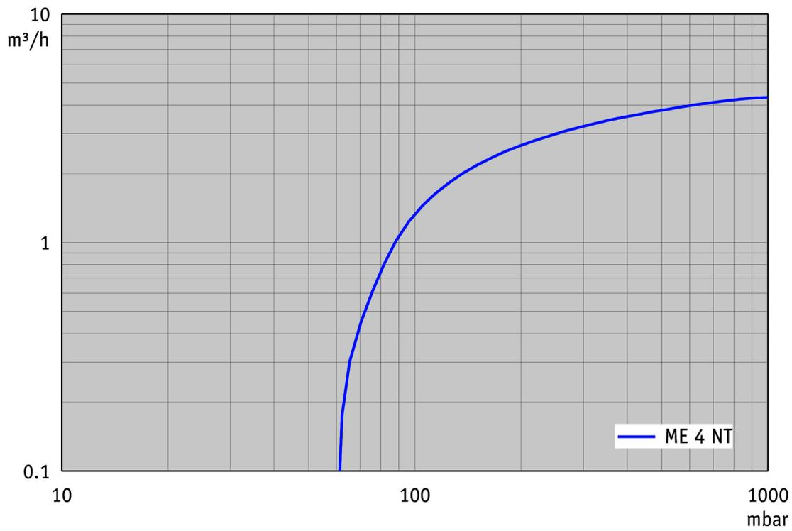
Abpumpkurve bei 60 Hz (10 l Behälter)
