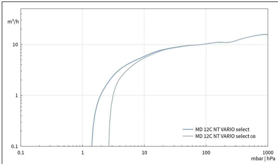
Abpumpkurve bei 60 Hz (100 l Behälter)
