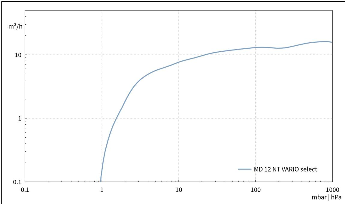
Abpumpkurve bei 60 Hz (100 l Behälter)
