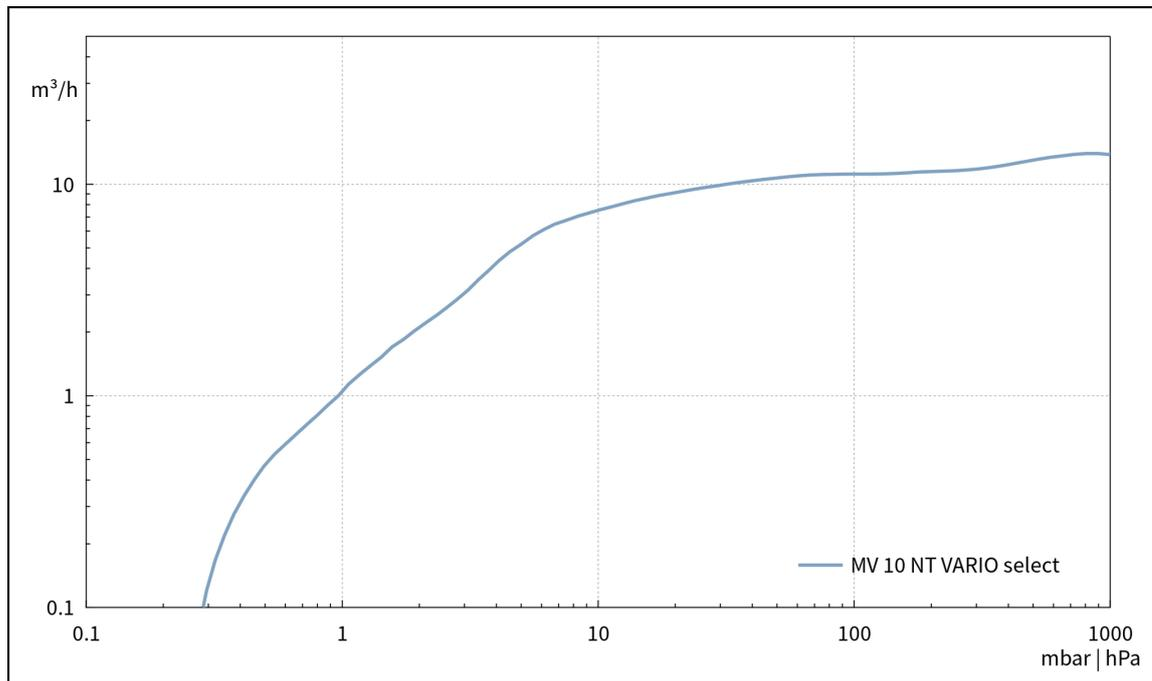
Abpumpkurve bei 60 Hz (100 l Behälter)
