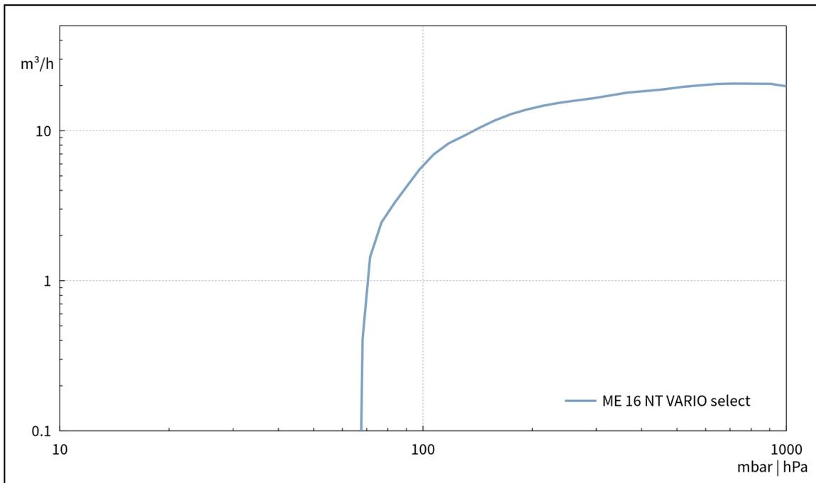
Abpumpkurve bei 60 Hz (100 l Behälter)
