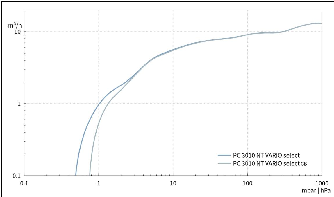
Abpumpkurve bei 60 Hz (100 l Behälter)
